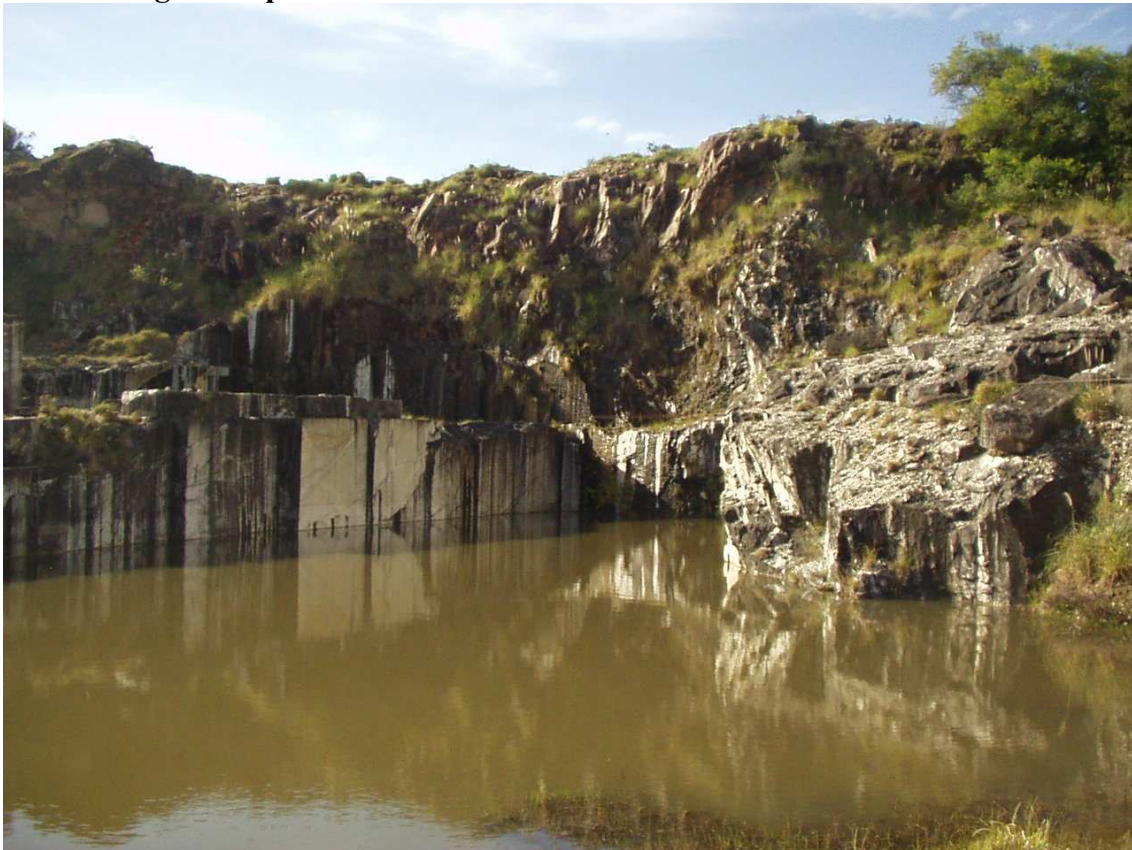
Foto 8: Vista de frente de cantera Piedrahita Hnos., cortes con hilo diamantado(Ficha 274 BDG)
