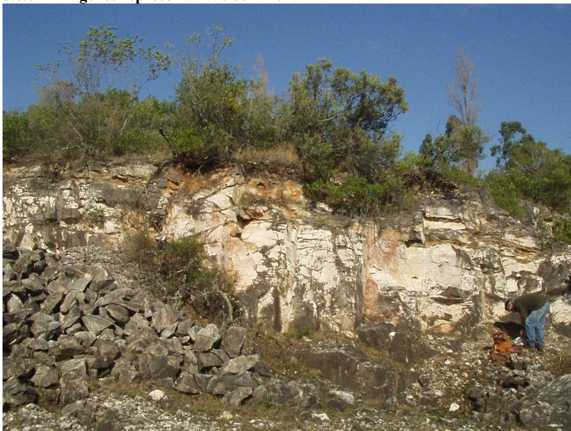
Foto 12: Frente de cantera de dolomita intensamente fracturada no apta para bloques.
