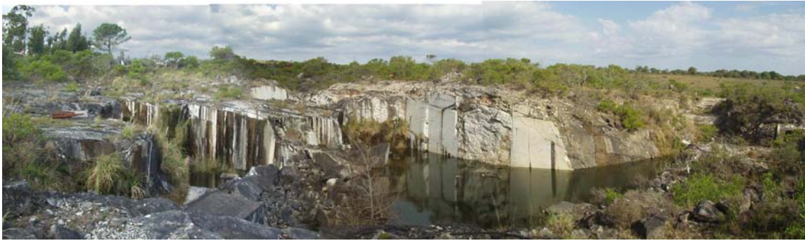
Foto 13 Frente de cantera de mármol dolomítico para extracción de bloques (Ficha 245 BDG)
